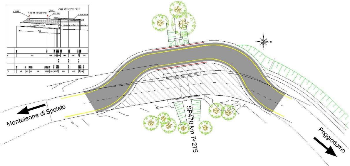
B) SP 470 – tra il km 7+690 e il km 7+840 – realizzazione di breve tratto stradale temporaneo sul lato sinistro (corsia minima cm 300 oltre le banchine da cm 50), dove deviare i flussi di traffico, istituzione di senso unico alternato regolato da impianto semaforico e limitazione di massa degli autoveicoli a 35 t. e sagoma a 10 m ;
